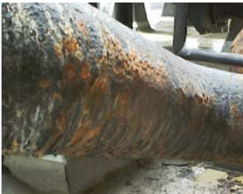
Patología por corrosión generalizada en tubería de acero
