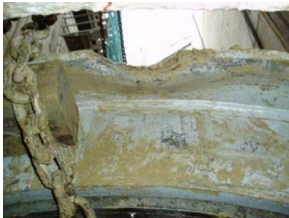
El mismo tipo de rotura del croquis anterior, sobre una tubería instalada mediante hinca
